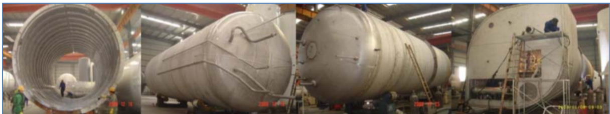
Abbildung 12 LNG-Tank Klasse C, vakuum-isoliert mit integrierter Cold Box Quelle: Wärtsilä
