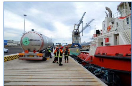
Abbildung 49 Pumpen vom Tankwagen zum Schiff
