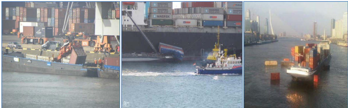
Abbildung 53 Bilder von Unfällen, bei denen Container über Bord auf ein tiefer liegendes Schiff fielen
